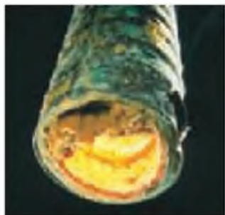
◀ Figura 18.21 Formación de Incrustaciones. Sección de una tubería de agua ha quedado recubierta por dentro con \text{CaCO}_3 y otras sales insolubles depositadas por el agua dura.
